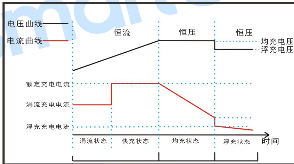
图1 三段式充电曲线图
