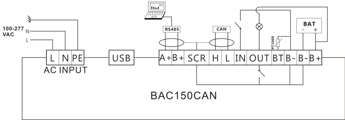
图4 BAC150CAN 接线图
