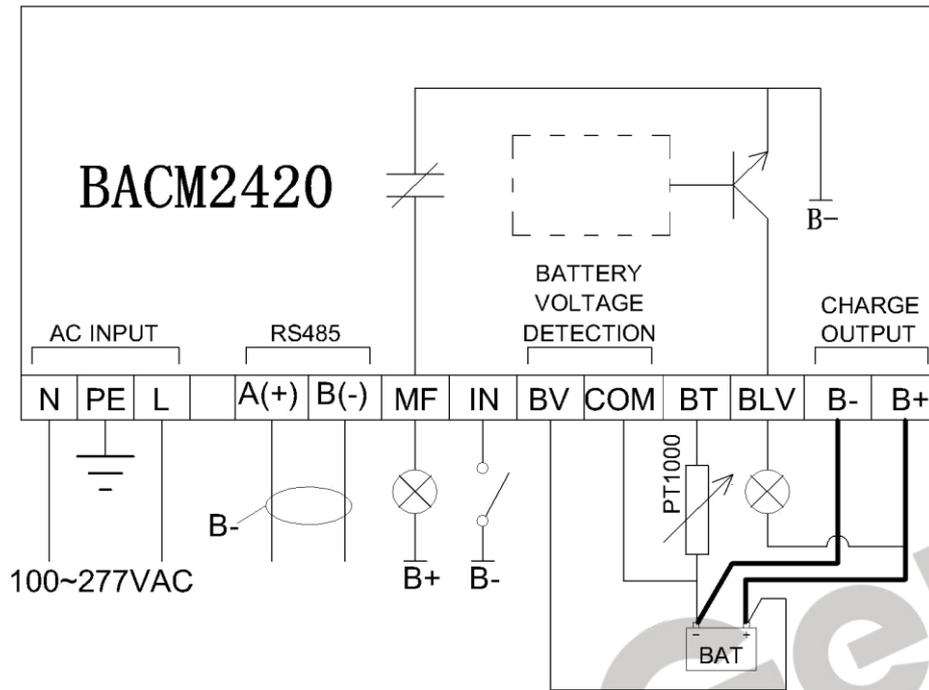
Fig. 5 Wiring Diagram
